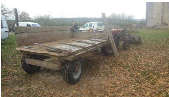
A la fin de l'année dernière, la remorque a subi un petit lifting bien nécessaire. Le platelage a été entièrement remplacé.
