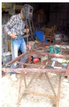
A partir de fer de récupération, une grille confectionnée et soudée par André est destinée à fermer la porte du premier étage de la tour de l'Ouest.
